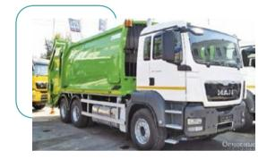
Мусоровоз GeesinkNorba GPM 15H25 с встроенным прессованием отходов (коэфф. уплотнения до 7 ед.)
